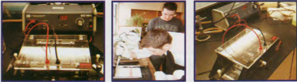
( شكل ٦٣ ) جهاز الهجرة الكهربائية و عملية حقن الحامض النووي على الجل و كيفية ظهور حزم الحامض النووي المفلورة على طبقة الجل تحت الأشعة فوق البنفسجية .
