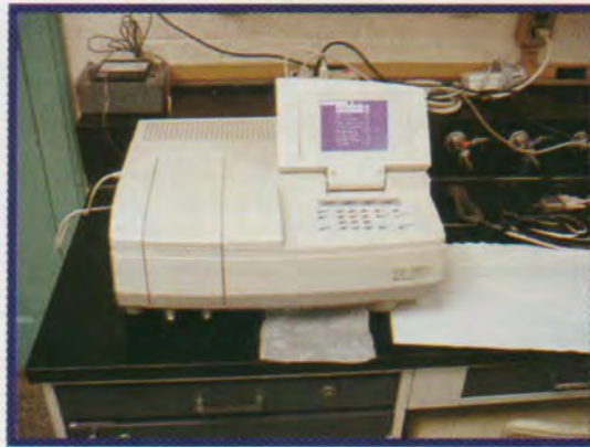
( شكل ٦٤ ) جهاز الاسبكتروفوتوميتر الذي يعمل اتوماتيكيا و الذي يستخدم في قياس تركيز الحامض النووي .
