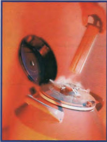
(شكل ٢١) تعقيم الأنابيب داخل جهاز الأوتوكلاف ضرورى منعا لحدوث تلوث .
