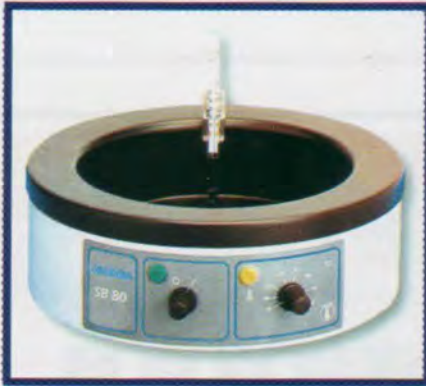
(شكل ٦٧) نموذج لحمام مائي يستخدم فى بعض مراحل عزل الحامض النووى .
