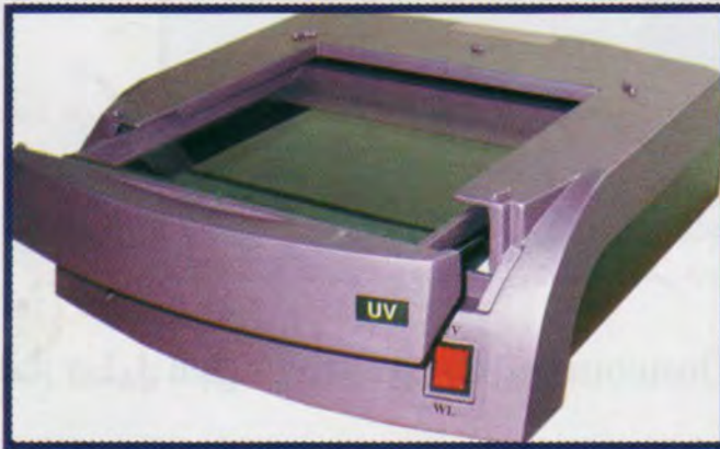
(شكل ٦٦) من خلال ماسح الحزم Transilluminator يمكن رؤية الحزم المغلورة للحامض النووي تحت الأشعة فوق البنفسجية .
