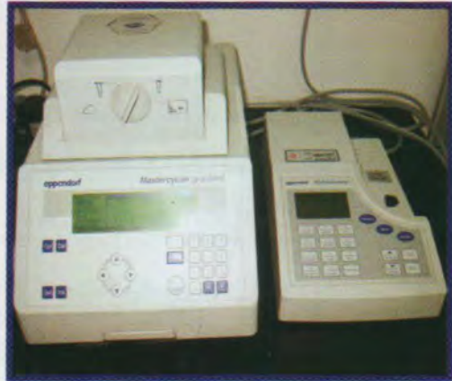
(شكل ٩) جهاز الـ PCR الذى يحدث داخله تفاعل الـ PCR (تفاعل البلمرة المتسلسل) ، حيث يتم صناعة بلايين النسخ من نسخة واحدة من الدنا .
